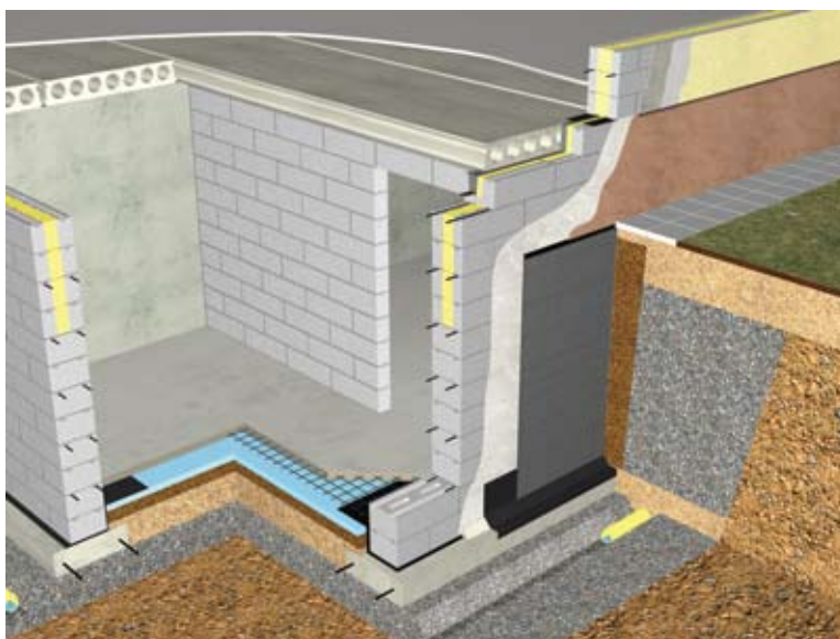
Kuva 4.8 C) Kellarillinen perustus: paikalla- valettu betoniantura.
