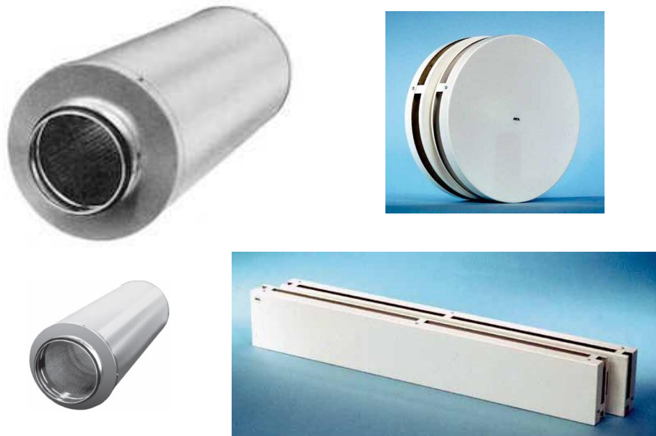
Kuva 11. Ilmanvaihtolämmitysjärjestelmän äänenvaimennusosia. Vasemmalla on kanavaäänenvaimentimia (IVK-Tuote Oy) ilmanvaihtolämmityskoneeseen ja huoneiden väliseen kanavaan. Oikealla on huoneiden välistä ääneneristävyyttä parantavia äänenvaimennettuja siirtoilmalaitteita (RCL Climecon).
