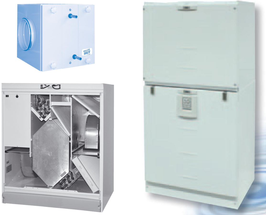
Kuva 12. Ilmanvaihtolämmityskone lisävarusteineen. Vasemmalla alhaalla on ilmanvaihtolämmityskone, jossa on sisään rakennettu maan lämpöä hyödyntävä esilämmitys- ja viilennyspatteri. Vasemmalla ylhäällä on maan lämpöä hyödyntävä erillinen esilämmitys- ja viilennyspatteri. Oikealla on ilmanvaihtolämmityskone, jonka päälle on asennettu äänenvaimenninyksikkö (Vallox Oy).
