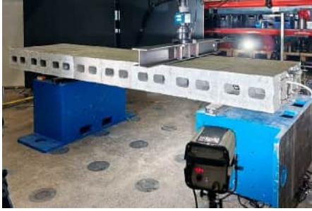
Kuva 4: Seinien kuormituksen koejärjestely
