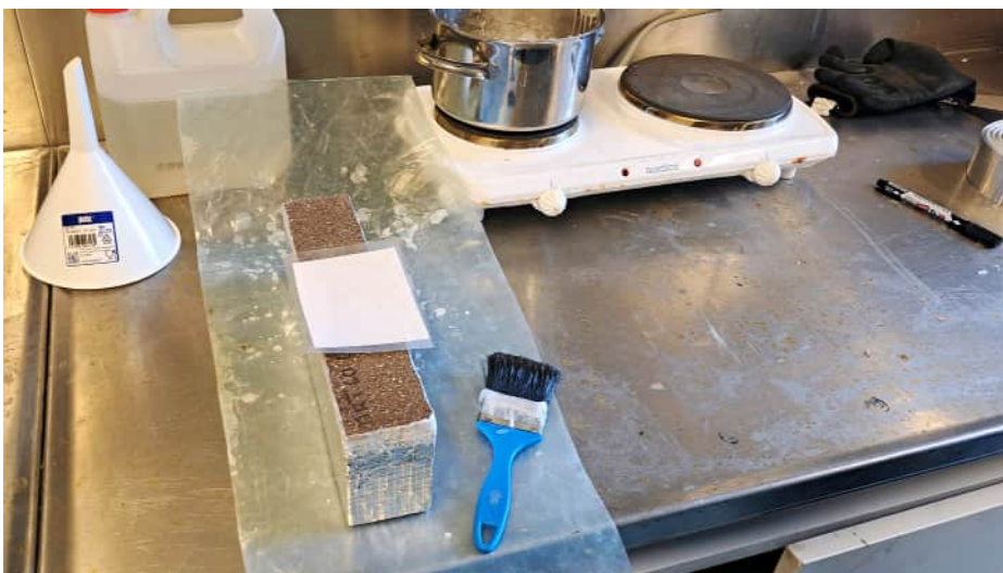
Tiilen sivut tiivistetty yksiulotteisen vedenimeytymisen tutkimiseksi.
