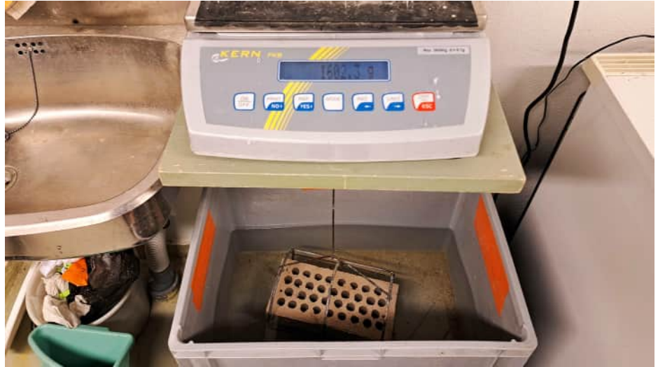
Tiilen massa mitattiin ripustettuna vesisammiossa.
