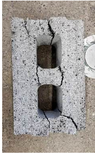
Kuva 2: Harkon vinopuristuskokeen järjestely ja harkko murtumisen jälkeen
